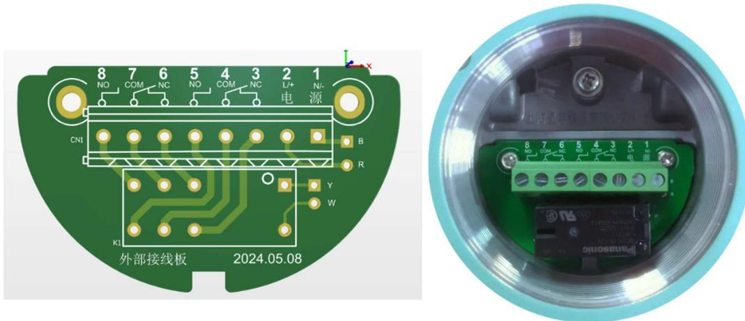
注：1) 对高温型产品，为保证内部参考地与容器金属壁可靠连接，接线端子地线必须连接。
