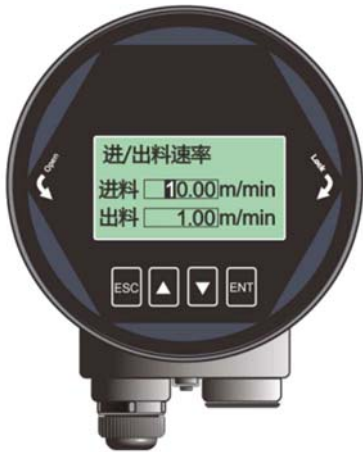
图 7 - 15 进/出料速率编辑界面
