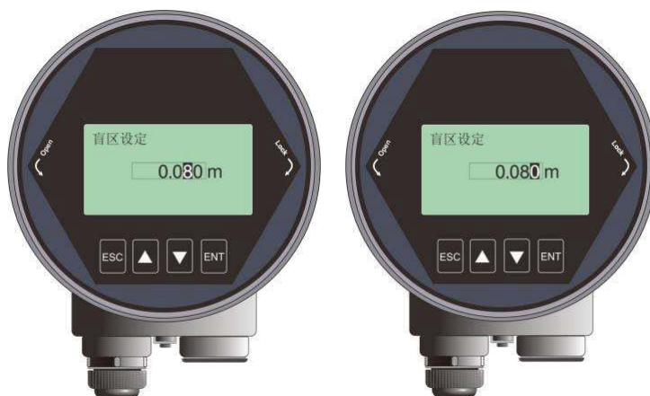
图 7-39 【DN（或下箭头）】键实现光标右移
