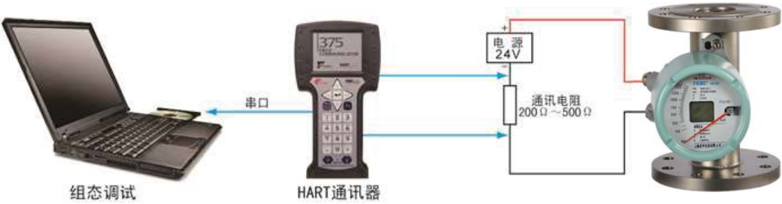
c) 带显示型流量计电气接线示意图
