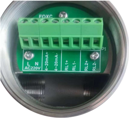
220V 供电接线端子示意图
