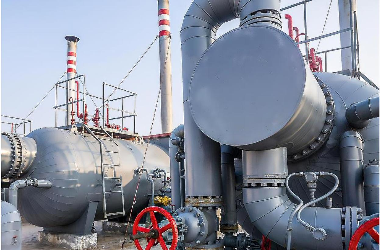
缓冲罐通常位于工艺装置之间，以帮助减少互相连接的工艺装置之间流量变化产生的影响。缓冲罐液位过低会导致产量减少，而液位过高会导致液体物料结转。在以交替的惯性和紊流为特征的应用中，稳定液位的输出是非常需要的。
